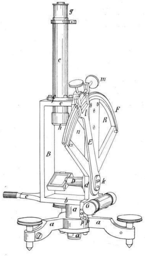
konische Ausbohrung zur Aufname der Vertikalachse a des Instrumentes.
