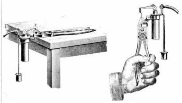
mindestens die eine Hand frei hat, um z. B. bei der Verwendung von sogen, lötfertigen Kontakten das Kabelende in den Kabelschuh einführen zu können und es bis zum Erkalten festzuhalten.
