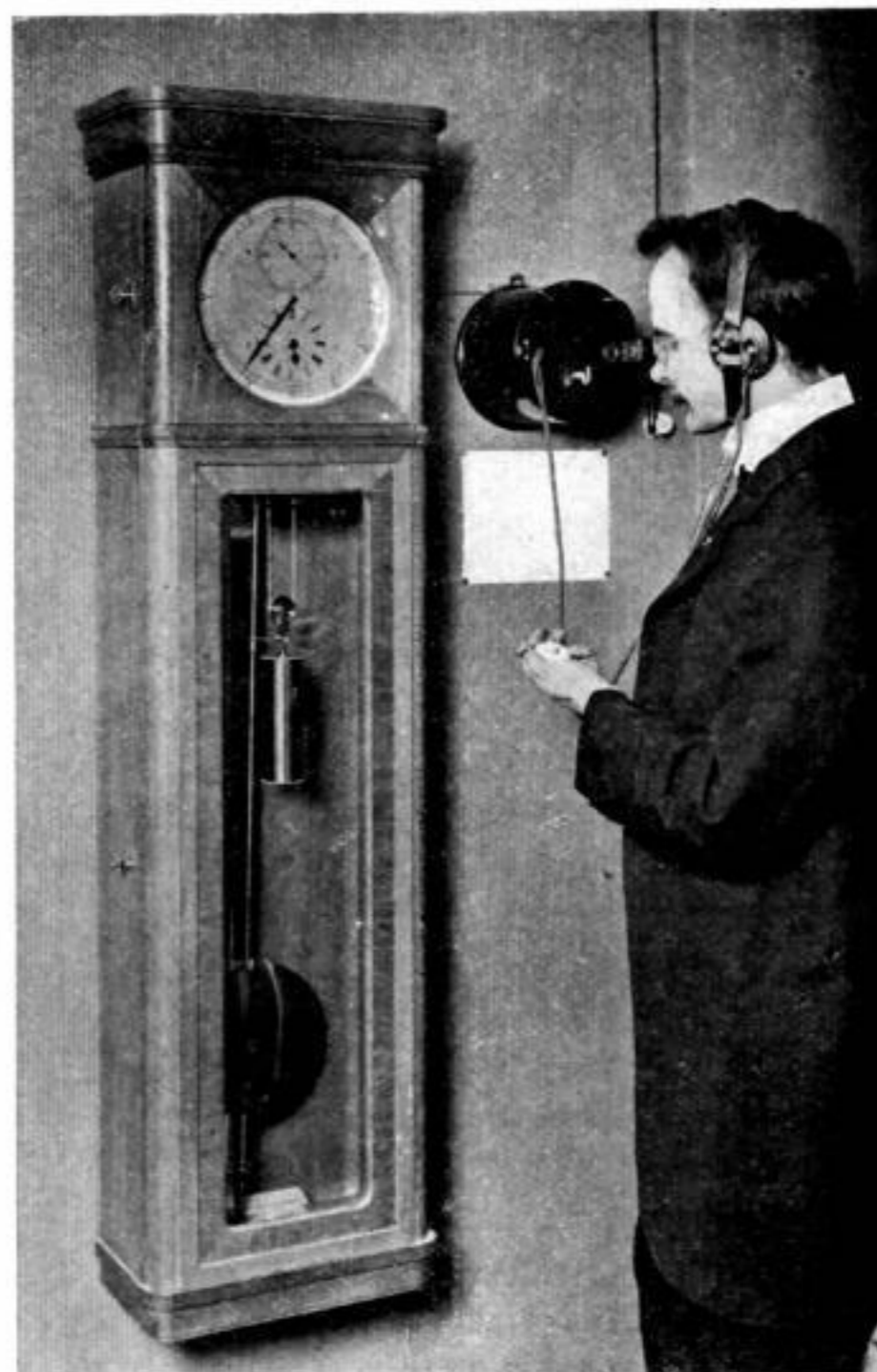
Fig. 3. Die Trappsche Beobachtungsuhr in Verbindung mit dem Empfangsapparat.
