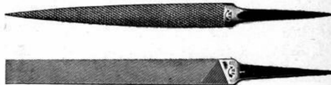
Flache Feile mit wellenförmiger Zahnung.
