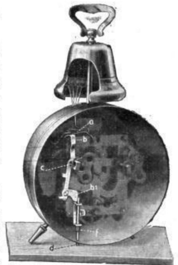
Die Klinke b1 ist zu dem Zweck angebracht, um den Stift d in seiner Höchststellung zu halten
