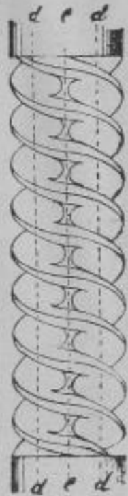
Fig. 62. Seitenansicht einer Schraube nach Fig. 60 mit 3 Gewindegängen.
