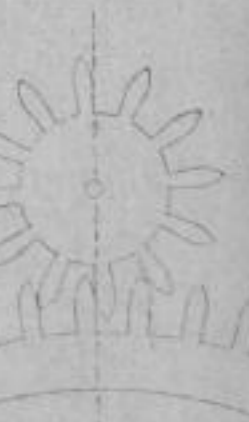
Fig. 77. Zwölfertriebseingriff. Rad- und Triebzahn gleichstark. Triebdurchmesser = 5 volle Zähne und 1/2 Lücke.
