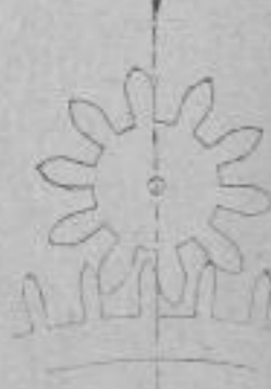
Fig. 72. Zehnertriebseingriff. Voller Rad- u. schwacher Triebzahn. Triebdurchmesser = 4 volle Zähne und 1/2 Lücke.
