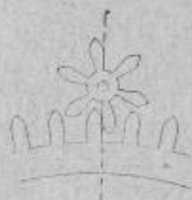
Fig. 65. Sechsertriebseingriff. Rad- und Triebzahn gleichstark. Voller Rad- u. schwacher Triebzahn. Triebdurchmesser = 3 volle Zähne reichlich.
