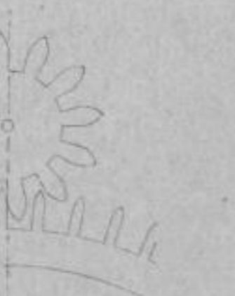
Fig. 76. Zwölfertriebseingriff. Schwacher Rad- u. voller Triebzahn. Triebdurchmesser = 5 Radzähne u. 1 Lücke.
