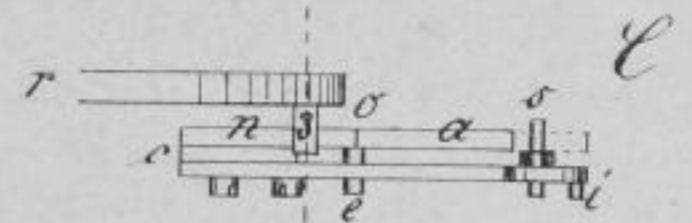
Fig. 118. Wie Fig. 117, der Hebel ist noch weiter nach rechts geschwungen, der Stift 2 hat die Hebungfläche verlassen, Stift 3 liegt auf der Klappe auf der Ruhefläche n auf, a ist die des Hebels rechts von o, dem Endpunkte der Klappe, die auch auf Stift e aufliegt. s ist der Drehpunkt der Klappe.
