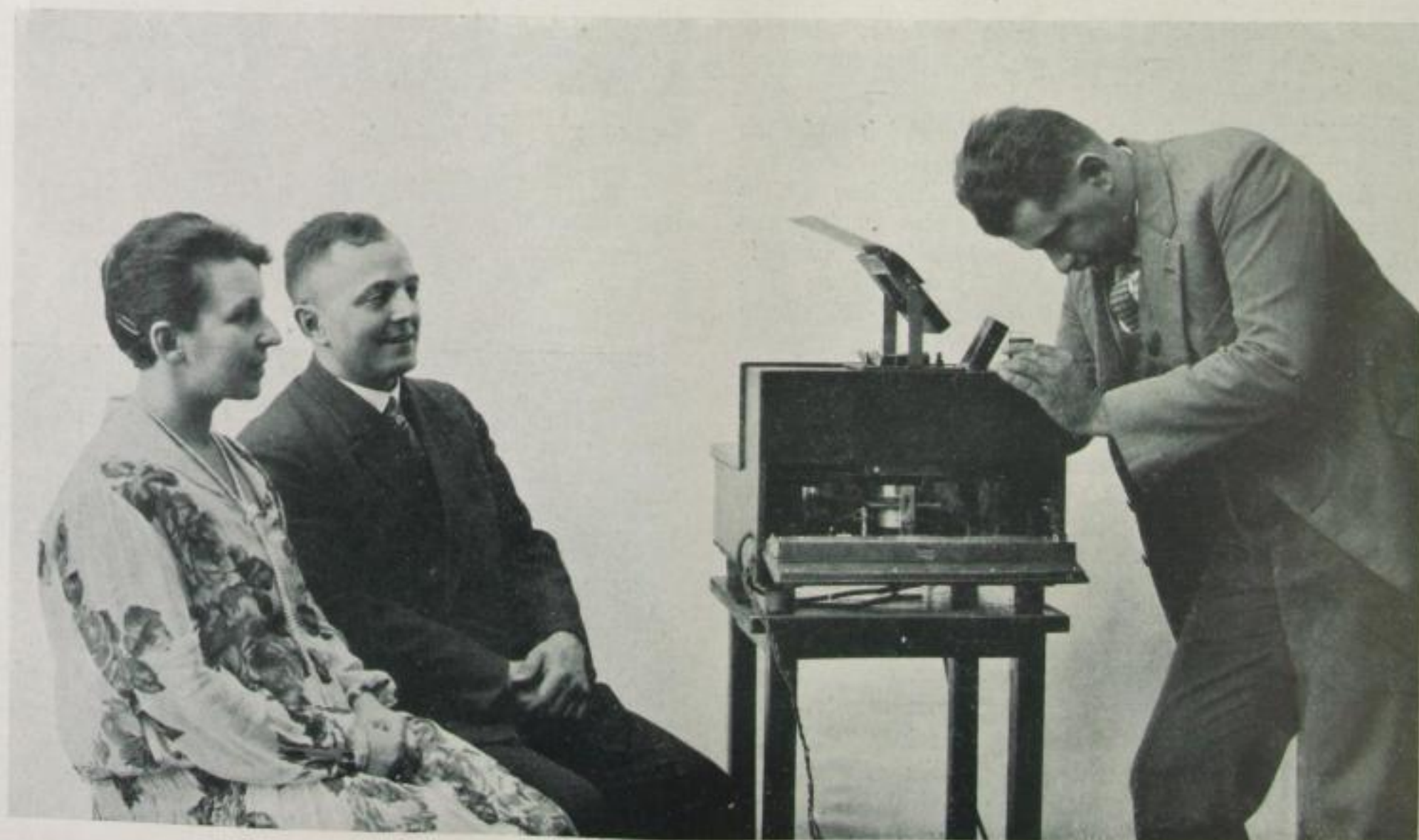
Tragbarer Tageslichtsender Der Operateur stellt das Objektiv auf die Scene ein.
