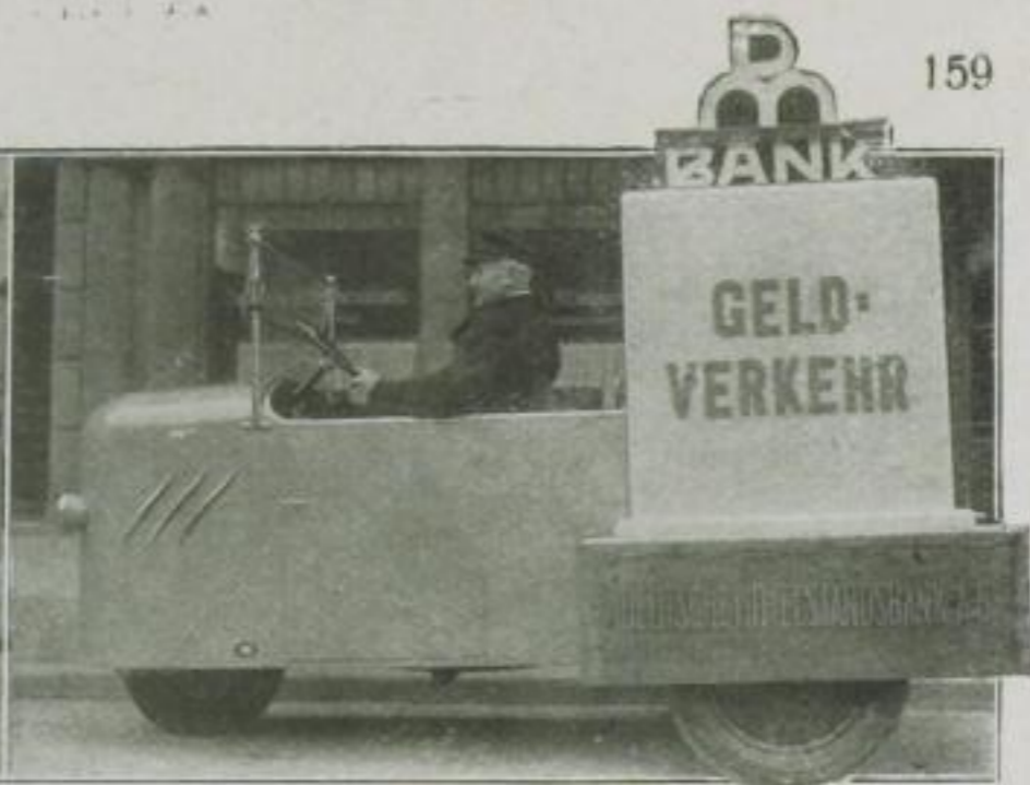
Panzerautos zum Geldtransport mit diebes- und feuersicherem Tresor
