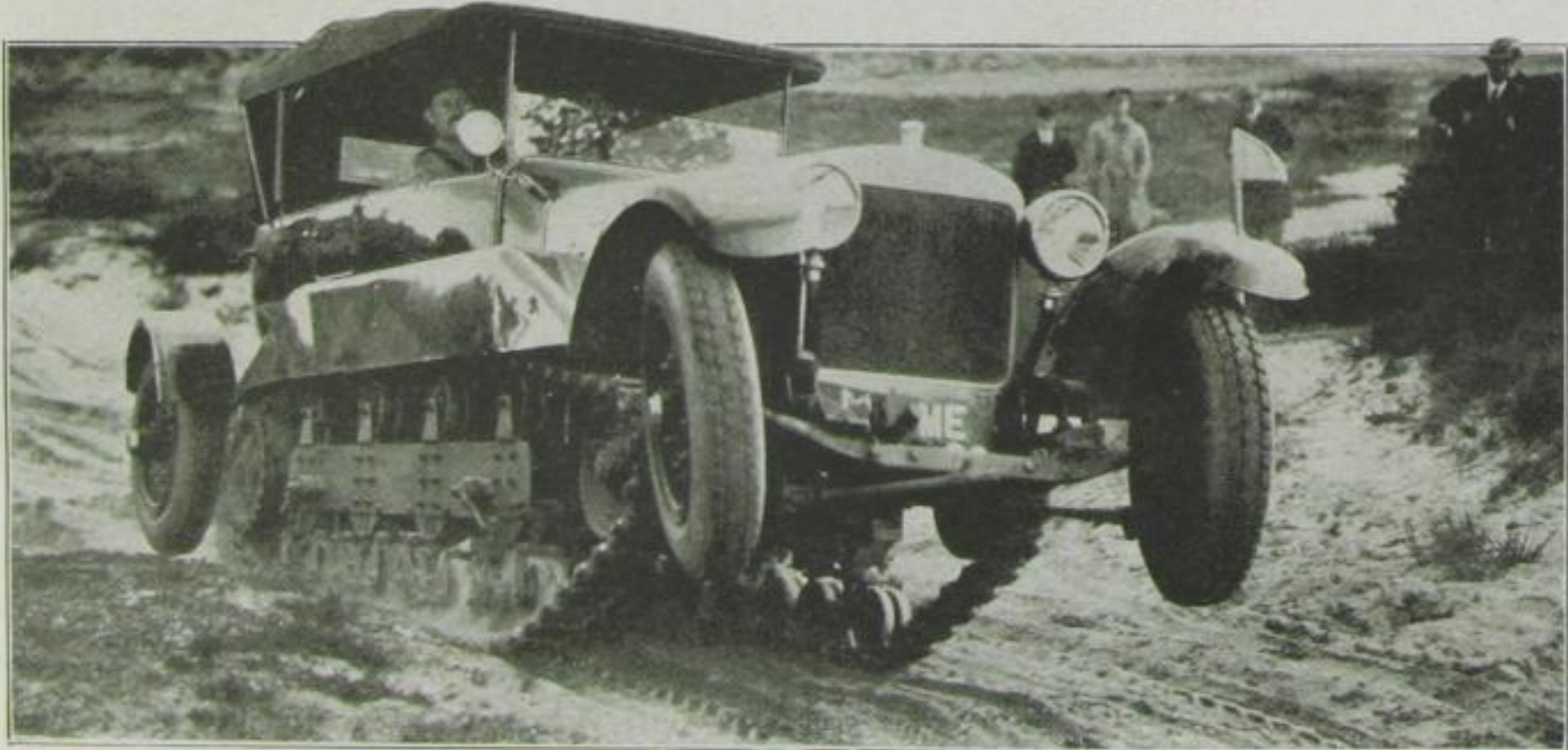
Raupen- und Tankwagen ermöglichen das Überqueren von Morasten, Sümpfen und gebirgigen Gegenden
