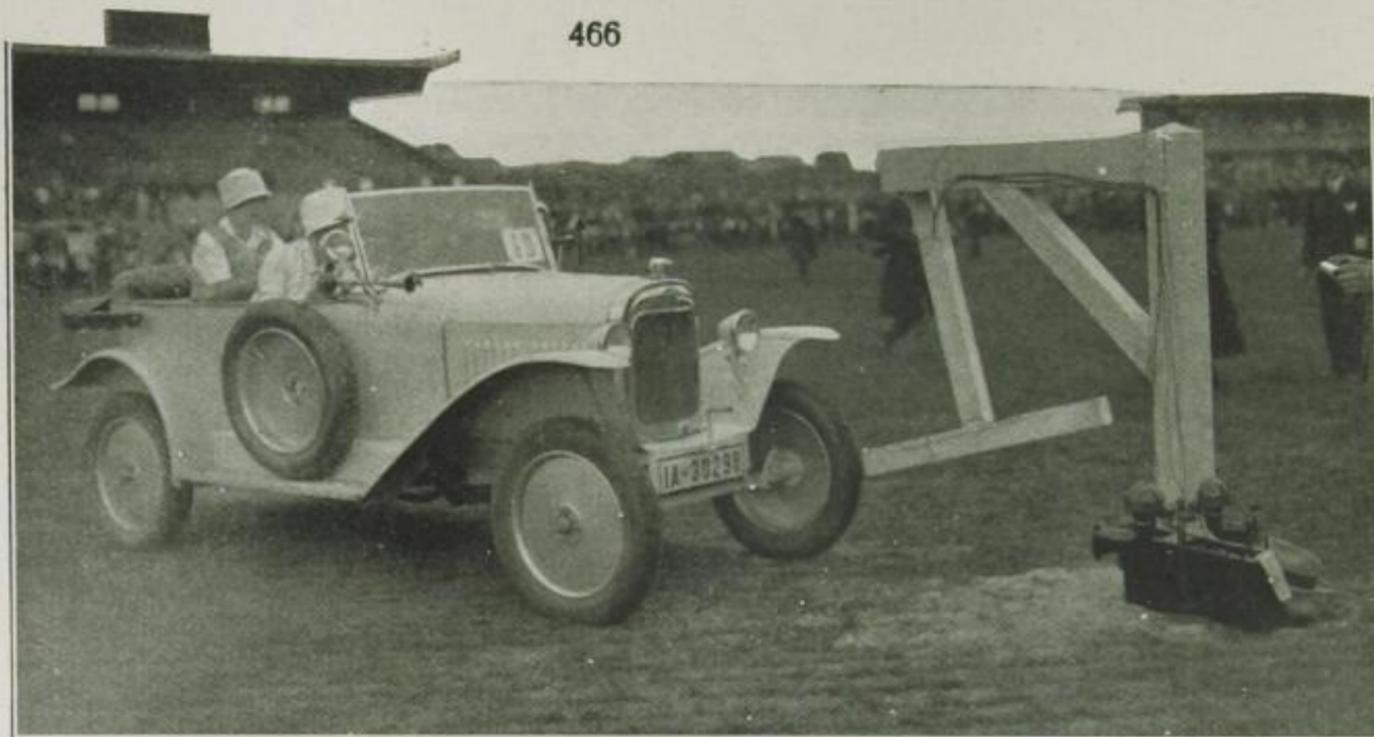
Anfahren einer elektrischen Signaleinrichtung mit dem linken Vorderrad
