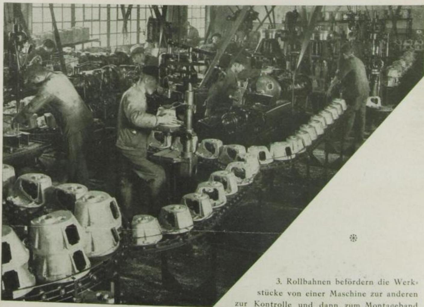
3. Rollbahnen befördern die Werkstücke von einer Maschine zur anderen zur Kontrolle und dann zum Montageband
