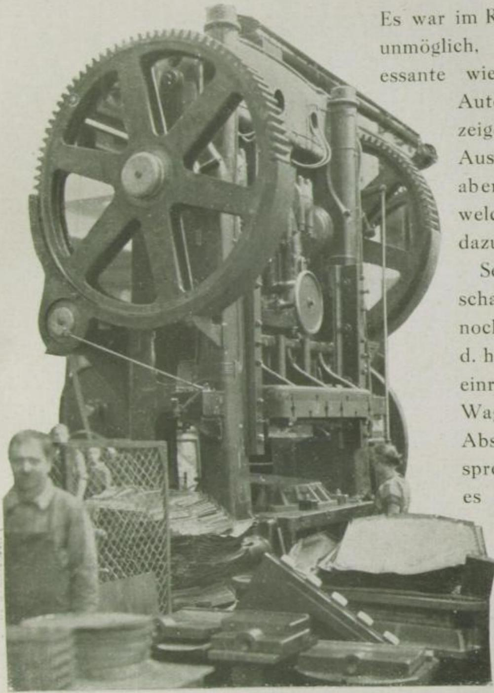
9. Eine große Tiefziehpresse zum Drücken von Karosserieteilen (diese Pressen wie sie bei Opel Verwendung finden, arbeiten mit einem Druck von 800000 bis zu 1 Million Kilogramm).
