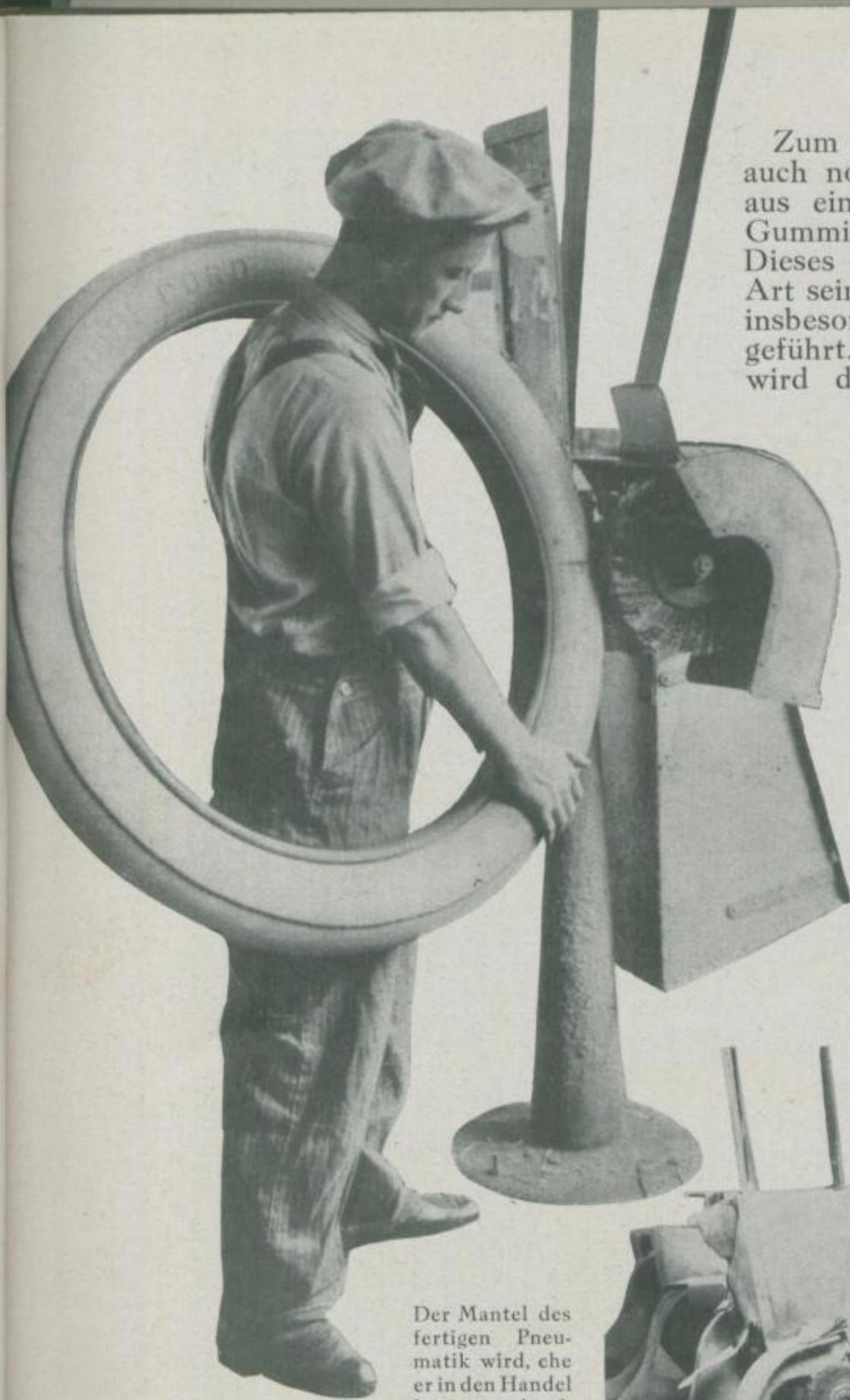
Der Mantel des fertigen Pneumatik wird, ehe er in den Handel kommt, durch sorgfältiges Abbürsten mit einer rotierenden Bürste von allen Spuren der vorhergehenden Behandlung befreit
