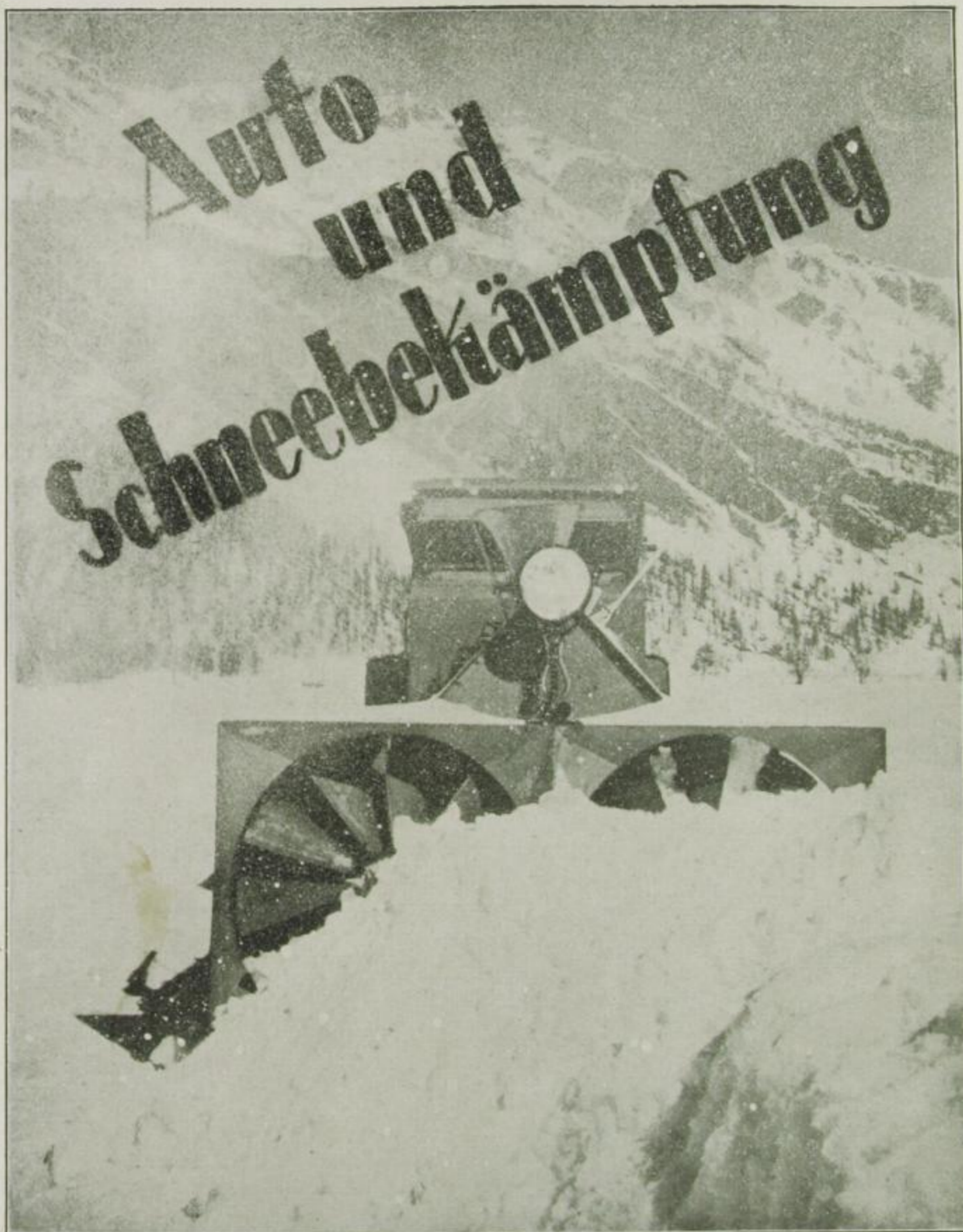
Ansicht der Schleuder von vorn. Man beachte den sauber abgeschnittenen Straßenrand
