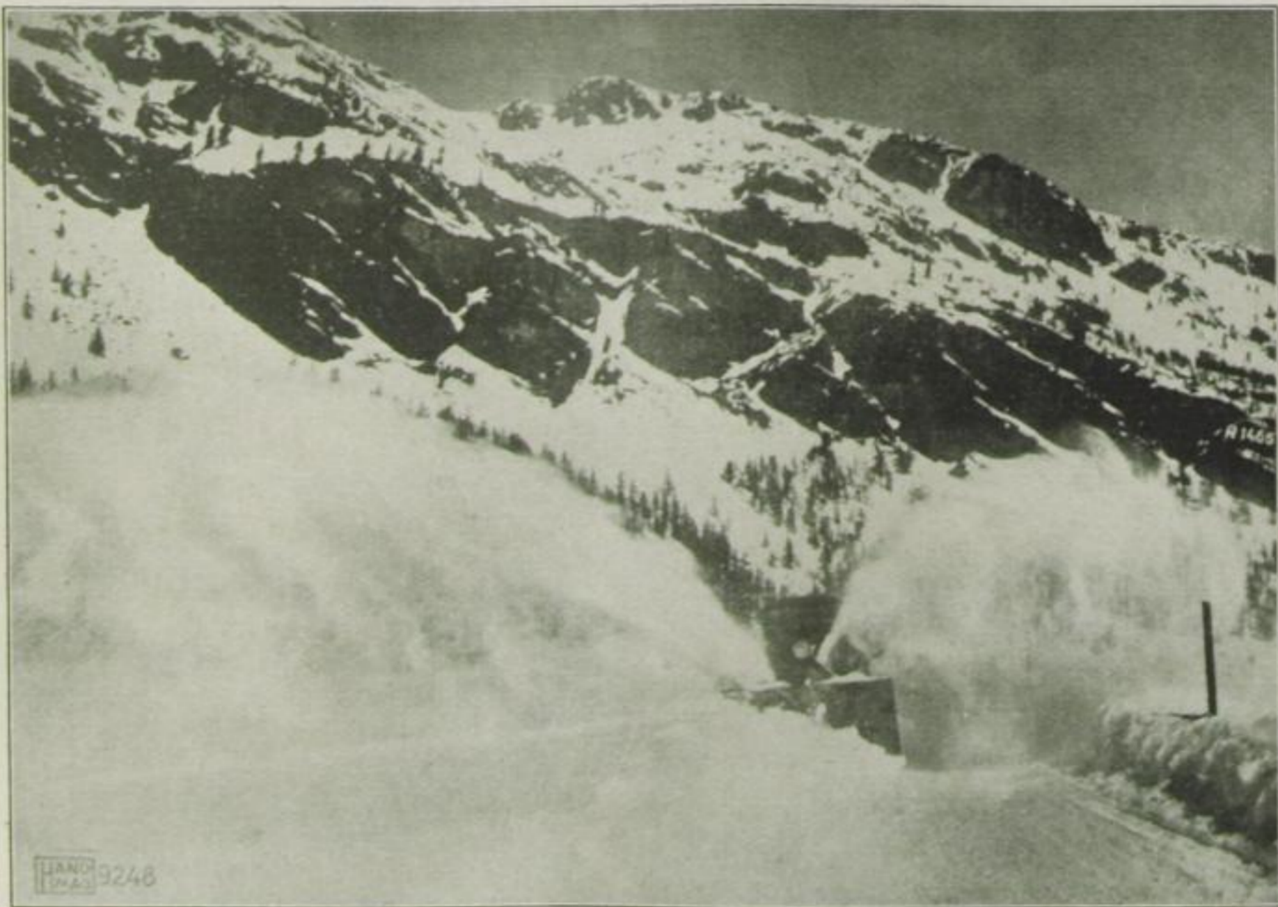
Hanomag WD-Kettenschlepper mit angebauter Schneeschleuder, 30 m Wurfweite bei 1,3 m hoher Schneelage
