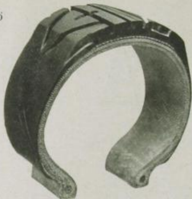
Querschnitt durch einen modernen Reifen
