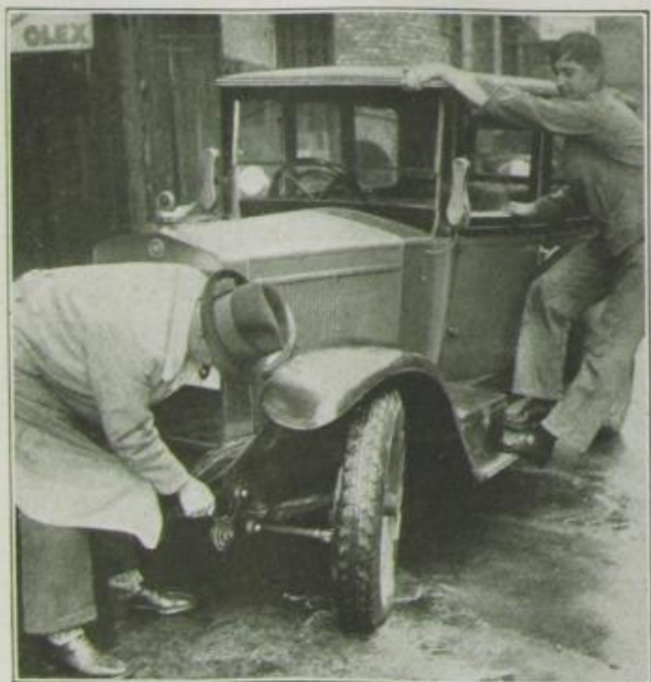
So wird der Reibungs-Stoßdämpfer richtig eingestellt (Deutsche Stoßdämpfer A.-G.) (III)
