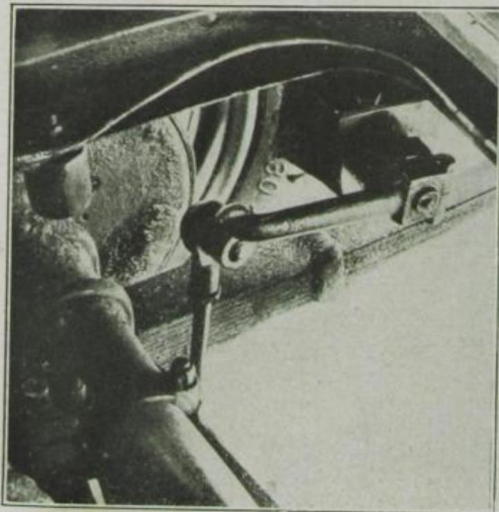
Der hydraulische Stoßdämpfer „Hydreß“ an einer Hinterfeder (VII)
