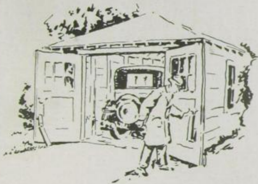
Fig. A. Diese bequeme Arretiervorrichtung besteht aus Brettchen mit Gehänge. Wenn außer Gebrauch, werden die Stützen nach oben geklappt und durch die Bügel festgehalten
