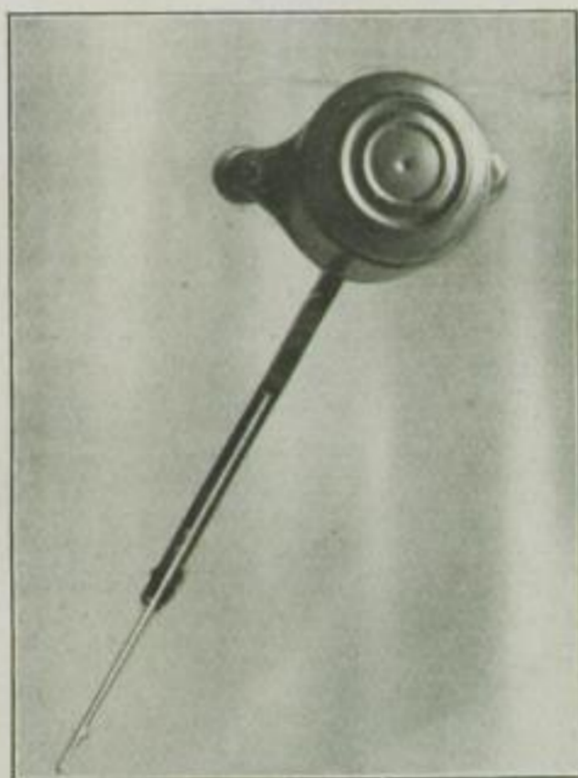
Der kleine Elektro-Scheibenwischer „Duplex“
