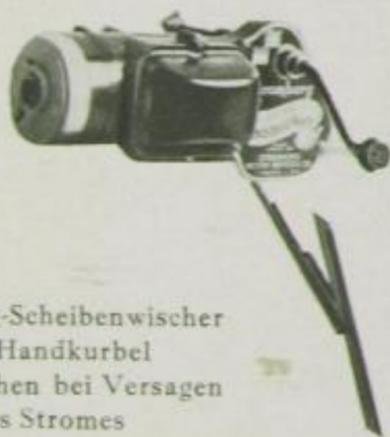
Stromberg-Scheibenwischer mit Handkurbel zum Wischen bei Versagen des Stromes
