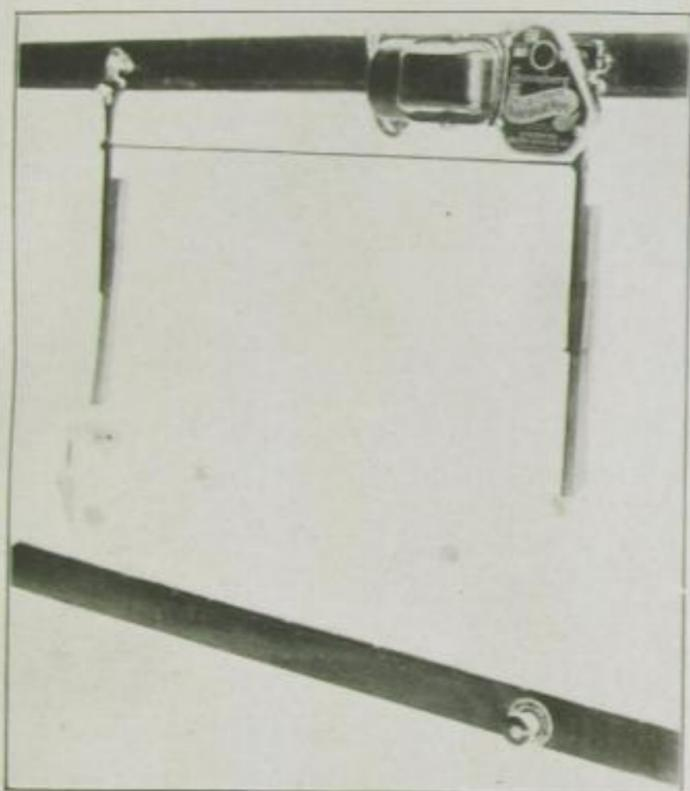
Stromberg-Scheibenwischer mit zwei Geschwindigkeiten und zweitem Wischerarm. Schalter unten am Rahmen
