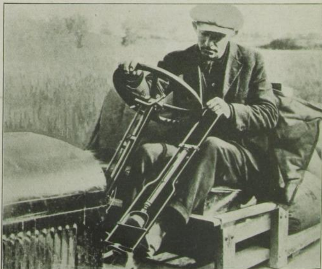
Prüfung der Fußpedalkraft im Fahrbetrieb
