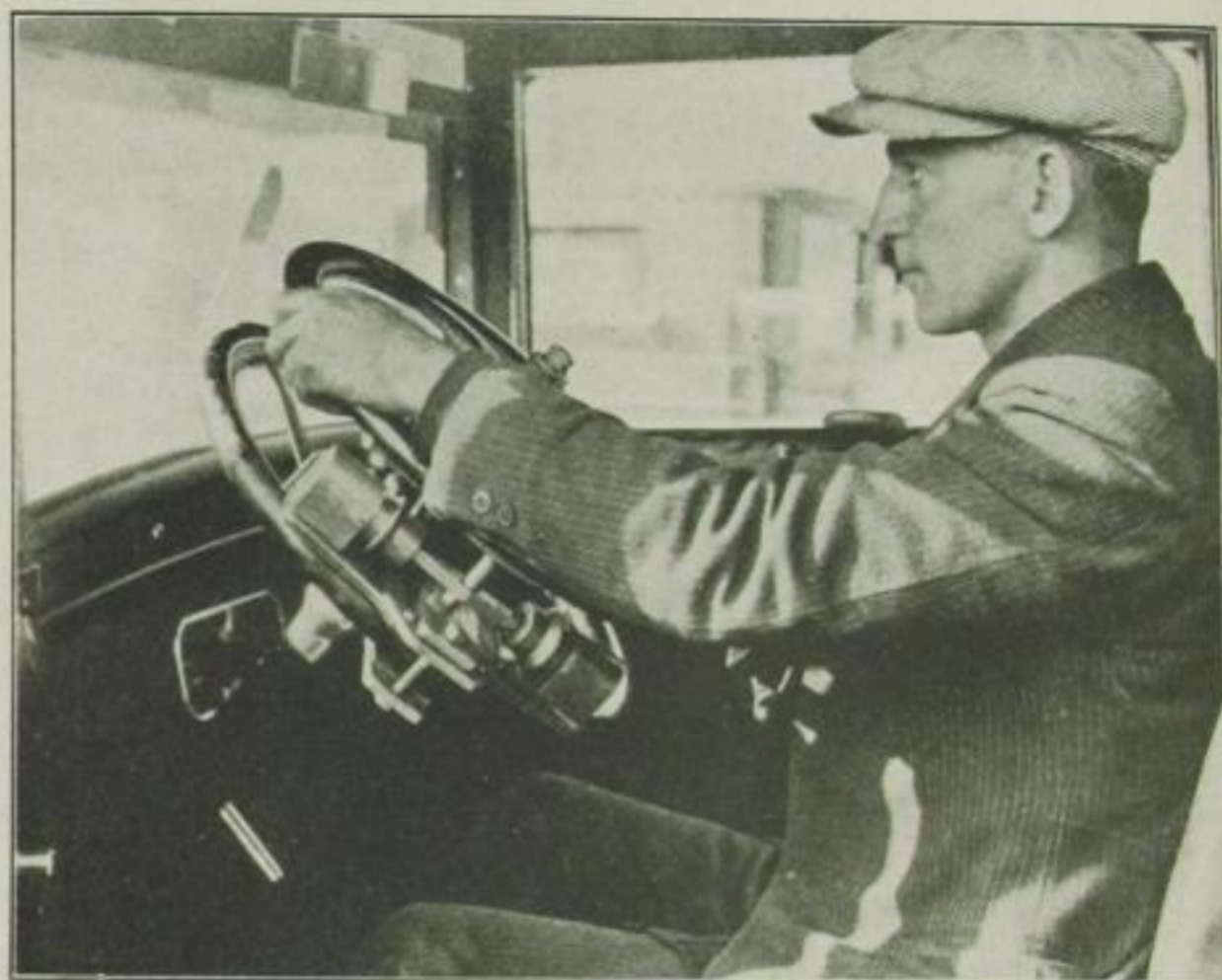
Prüfung der zum Lenken erforderlichen Kraft
