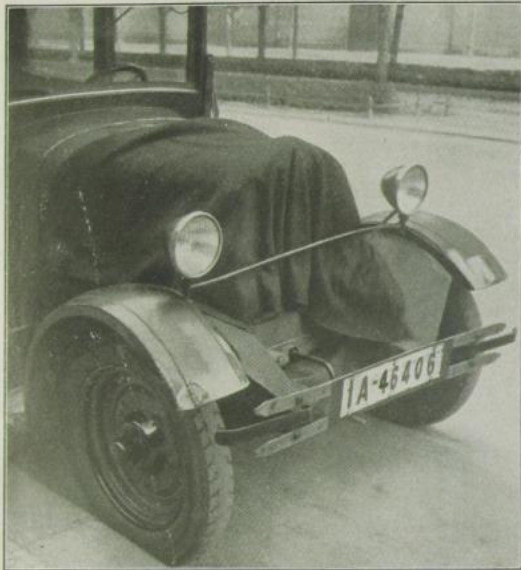
So schützte man früher den Kühler: durch Überwerfen einer Decke – heute höchstens ein Notbehelf
