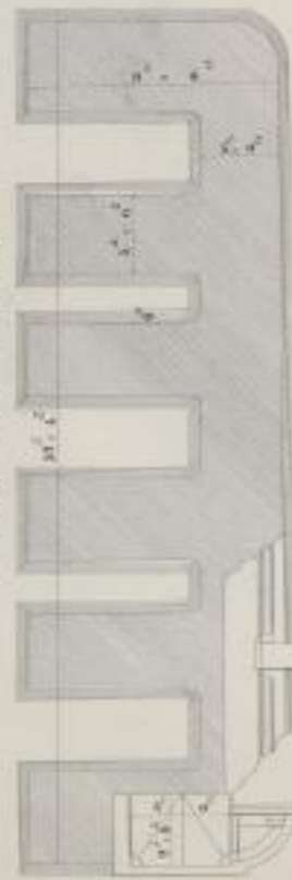
Grundriss der Fundamente
