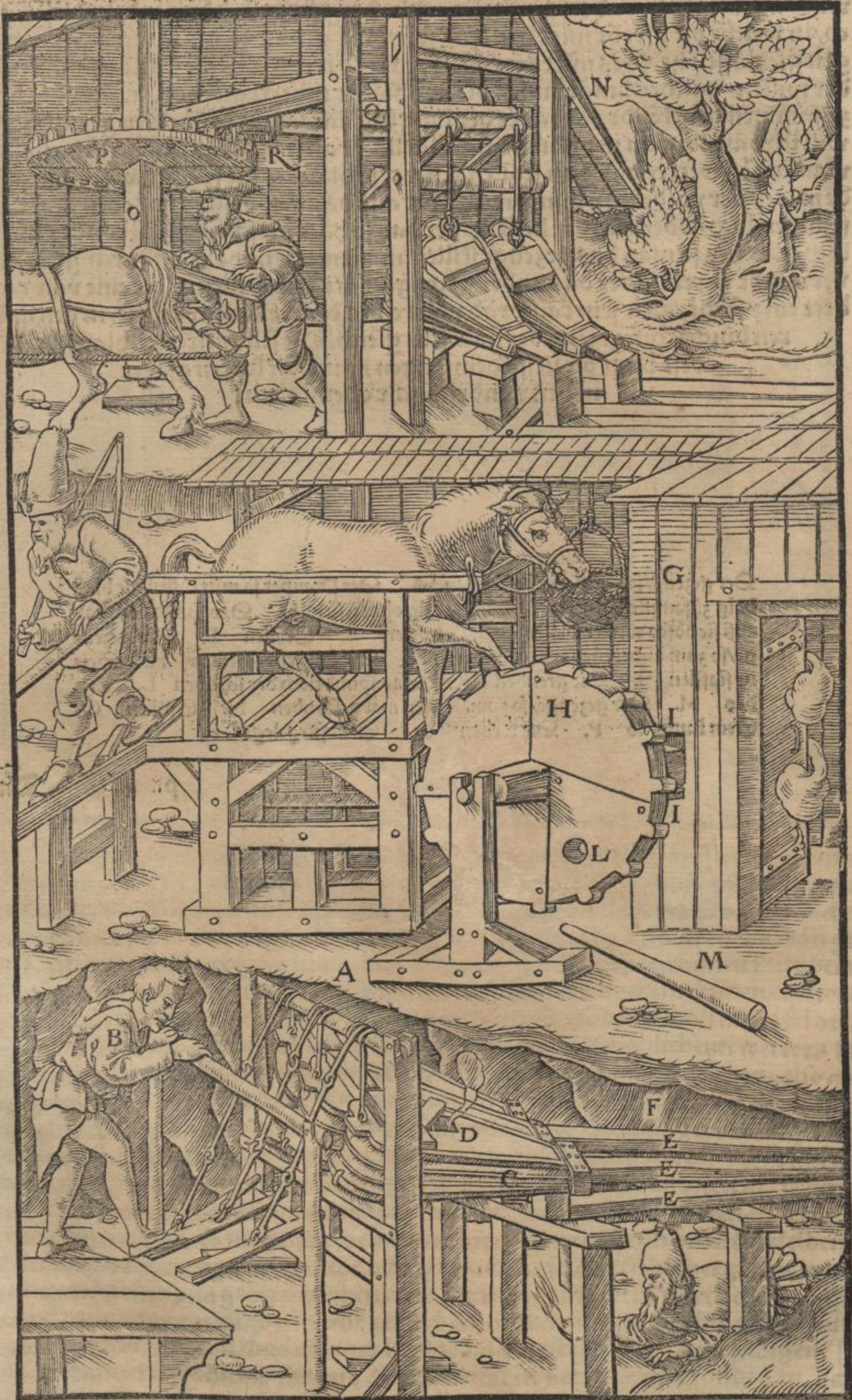
Das aber diese nächste rüstung das böß wetter des windtschachts vnd stollēs könne besseren / so ist auch die alte weiß für vnd für mitt leilachen zii fochern/ welche
