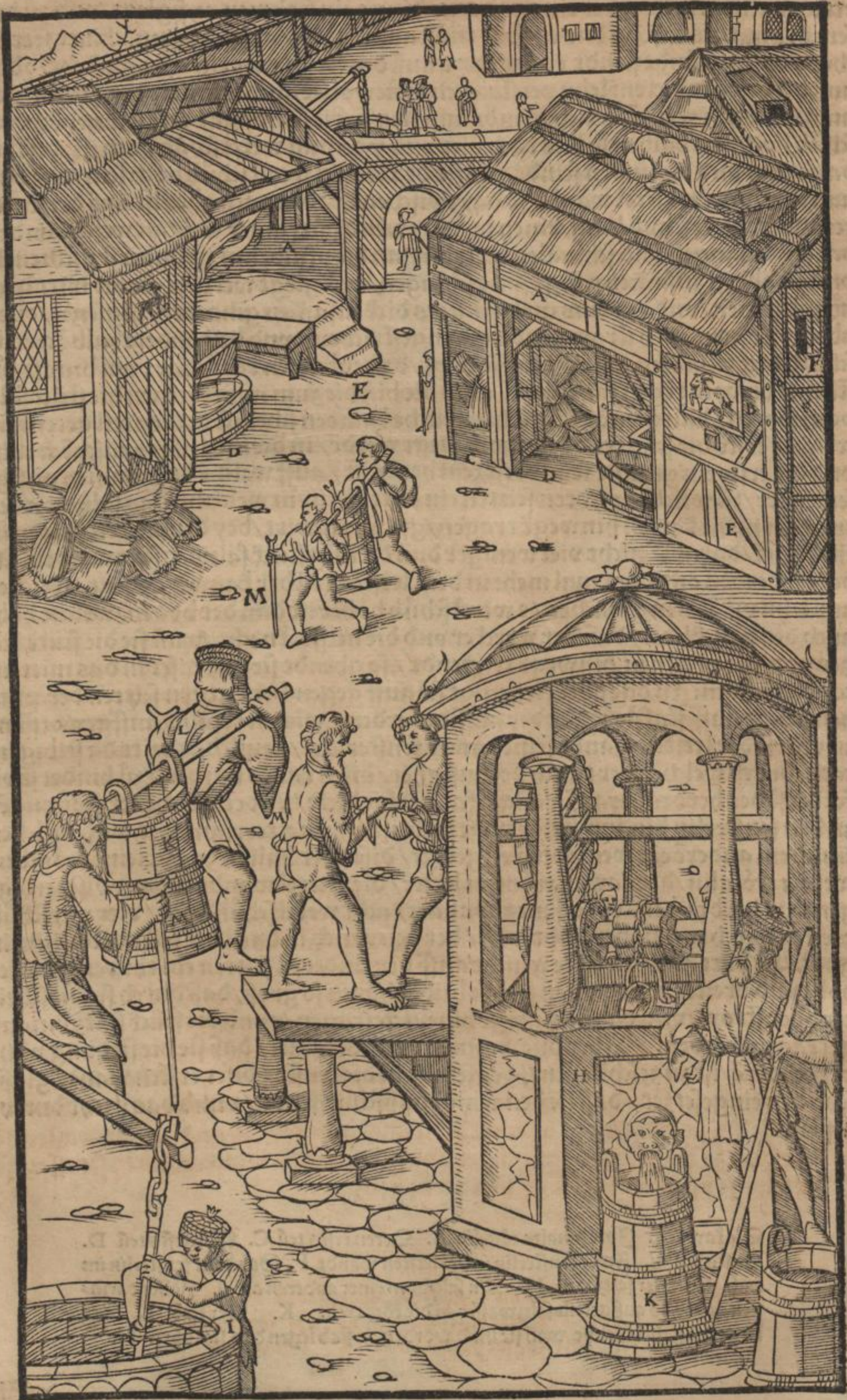
Sie machendt der mehrer teil den herdt auß saltzsteinen/ vnd erdē mitt saltz vermischet vnnnd auch gfeuchter/ welche mauren sehr hart vnnnd vhest vom feur werden/
