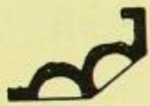
Fig. 370. Fenster- gewände am Treppenhaus.
