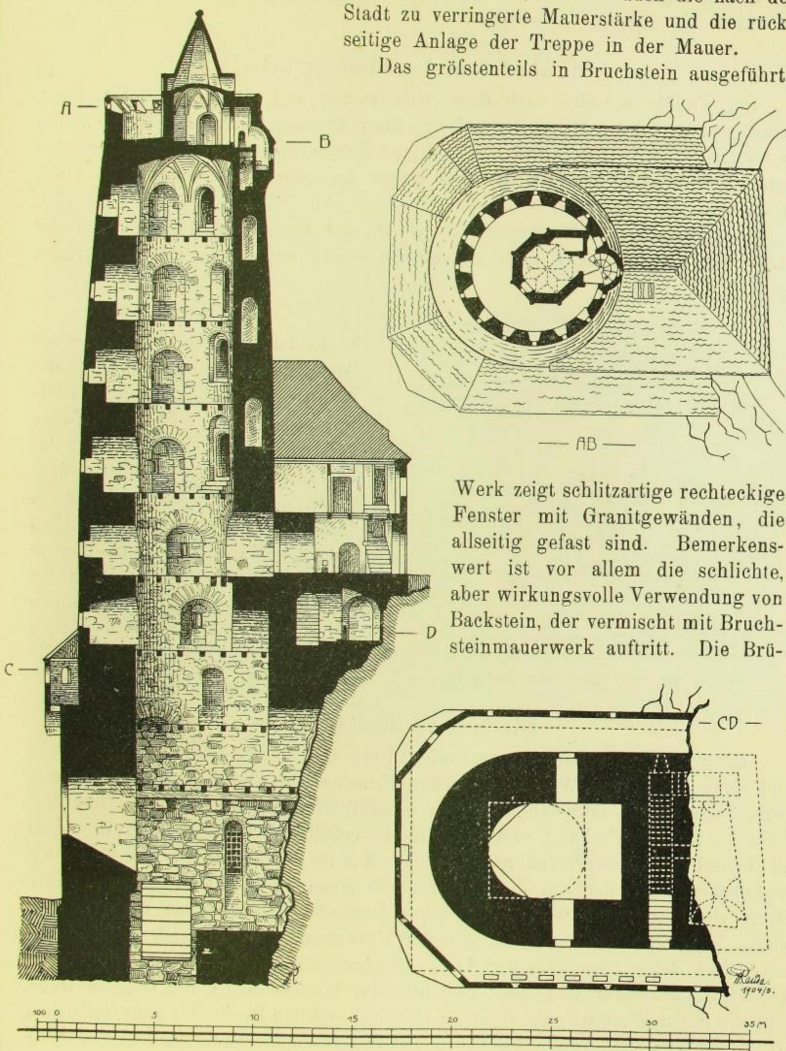
Werk zeigt schlitzartige rechteckige Fenster mit Granitgewänden, die allseitig gefast sind. Bemerkenswert ist vor allem die schlichte, aber wirkungsvolle Verwendung von Backstein, der vermischt mit Bruchsteinmauerwerk auftritt. Die Brū-
