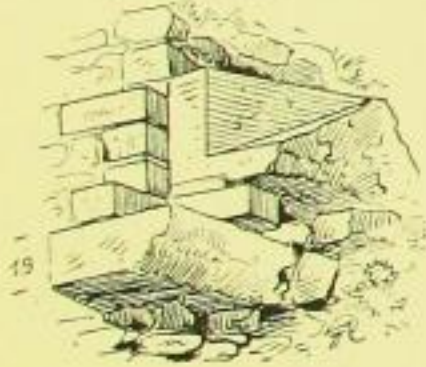
Fig. 311. Fensterbank der Apsis.
