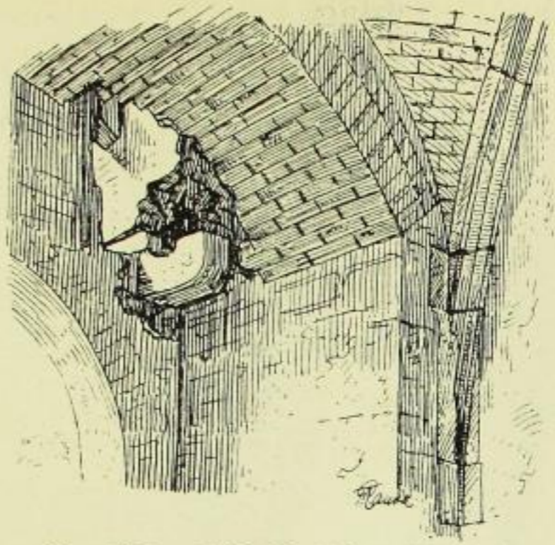
Fig. 681. Schloßbrücke, Vordertor, Anlage für den Zugbalken.
