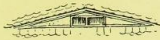
Fig. 274. Ponickau, Kirche, Dachfenster.
