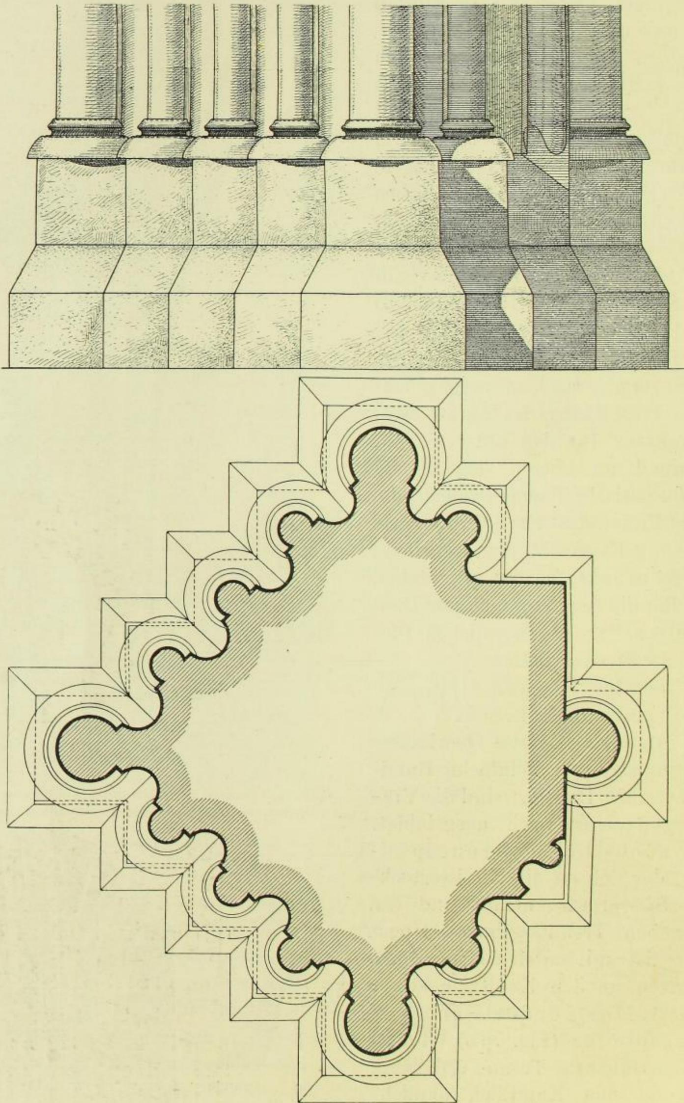
Fig. 76 und 77. Die westlichen Vierungspfeiler. Maßstab 1 : 20. Sockel und Grundriß.
