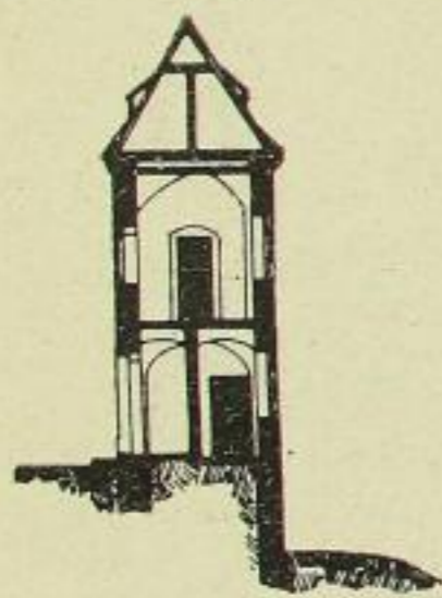
Fig. 204. Radeberg, Schnitt durch das Thorhaus, bei D.
