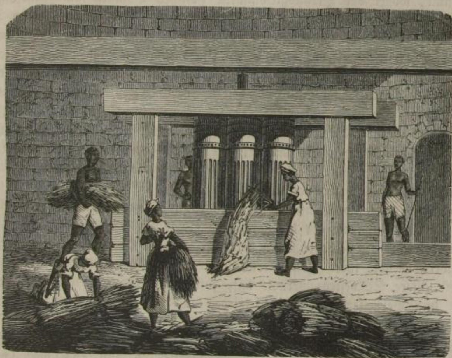
Fig. 25. Inneres einer Zuckerrohrquetschmühle.
