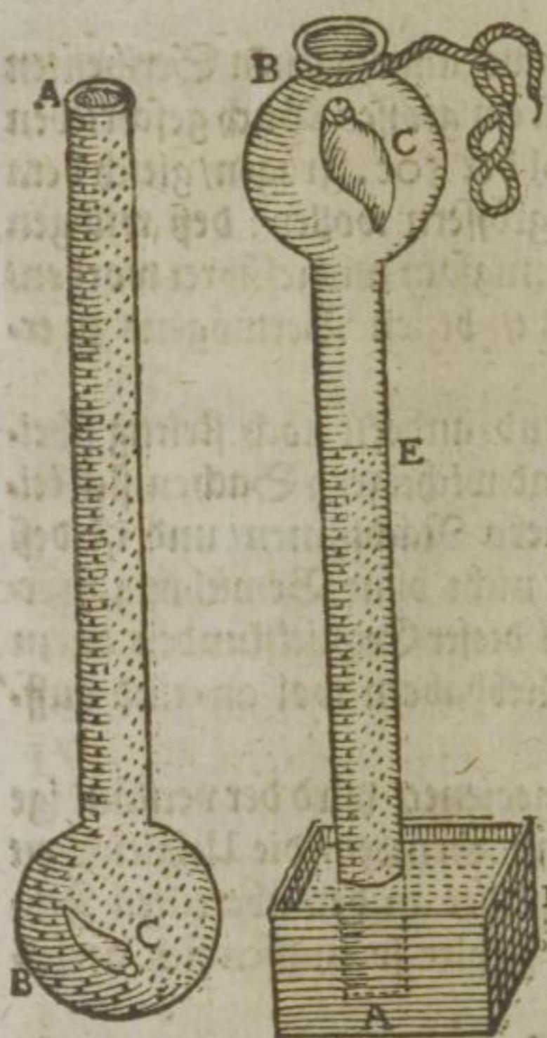
und auff das genauste hatte ausgedrucket. Darauff hat er das Glas A B bis oben an mit flüssigem Quecksilber angefüllt / mit dem Finger bey A zu gehalten / und in das Gefäß D. getaucht / welches gleichfalls mit Quecksilber angefüllt gewesen.
