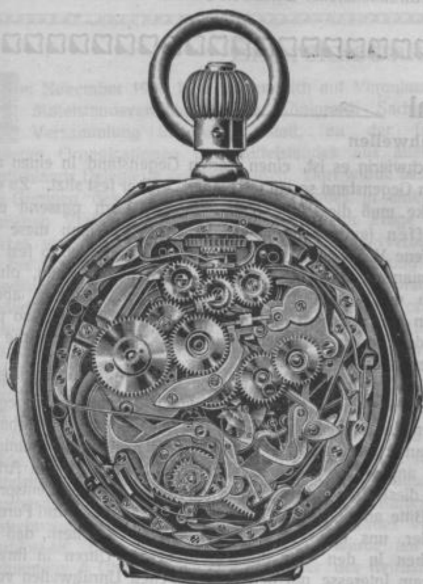
Fig. 3. Die Vorderseite der Werkplatte nach Abnahme der Anrichtungsplatte
