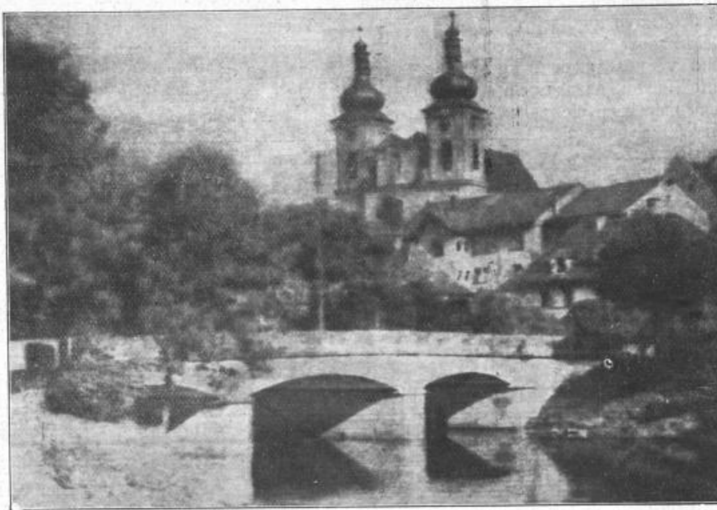
Fig. 23. Eine auf 2000 Kilometer telegraphierte Photographie (ausgeführt mit dem Bellinschen Bildertelegraphen in Paris)
