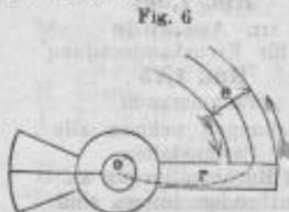
Nehmen wir an, dass die Unruhe so gedreht ist, dass die Radien der Spiralfeder kleiner geworden sind, so werden die äusseren Fibern verlängert und die inneren verkürzt worden sein. Sie haben aber das Bestreben, ihre ursprüngliche Länge wieder anzunehmen und üben daher auf den Arm der Spiralfeder eine Kraft aus, deren Richtung durch die beigeetzten Pfeile angegeben ist.
