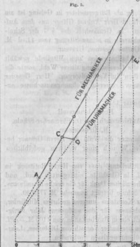
z. B. die 100fache (gemessene oder berechnete) Ganghöhe, und verbindet die Endpunkte aller letztgenannten Senkrechten, so ergeben die Verbindungslinien aller dieser Punkte eine gerade Linie für die Kluppengewinde, dagegen besteht sie aus einer gebrochenen Linie für die Schneideisengewinde, wie Fig. 5 darstellt.
