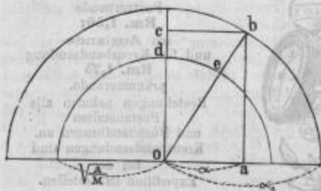
Die Zeit wird ausgedrückt durch den Bogen d e, dessen Radius  $= \sqrt{\frac{A}{M}}$  ist, und dessen sinus  $= \frac{bc}{bo} = \frac{\alpha}{\alpha_0}$  ist.
