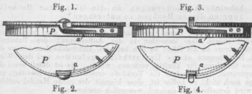
feder zu ist die Ausfräsung a, wie in Fig. 2 und 4 sichtbar wird, etwas tiefer gehalten, so dass die Feder während ihrer Anspannung Raum zum Ausweichen hat.
