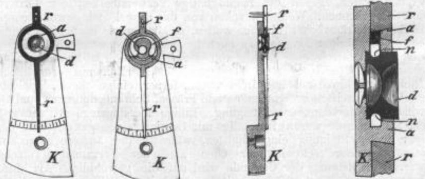
Der Rückenrücken r, Fig. 1—4, ist auf einen leicht unterdrehten Putzen oder Ansatz a des Unruhklöbens k aufgesprengt. Dieser Ansatz a enthält in seinem Mittelpunkt eine Ausdrehung, in welche das mit
