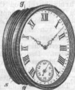
Werk kann nun mit Leichtigkeit in das Gehäuse eingeschraubt werden und ist so adjustirt, dass die Zahl XII gerade unter dem Bügel sitzt, wenn das Werk ganz festgeschraubt ist. Zum leichteren Festhalten beim Ein- und Ausschrauben ist der Glasreif rändrirt.
