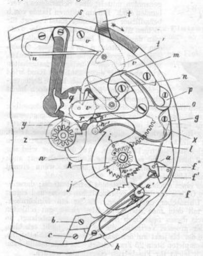
Die Auslösung erfolgt, wie bei den meisten neueren Repetiruhren, mittelst eines seitlich am Mitteltheil des Gehäuses angebrachten Schiebers, der einem entsprechend breiten Einschnitt den Riegel t umschliesst und ihn mit sich nimmt, sobald der Schieber von Hand verschoben wird. Sowie man denselben loslässt, werden durch die kräftige Feder u der Riegel t sowie der äussere Schieber wieder in ihre Ruhelage zurückgeschnellt.
