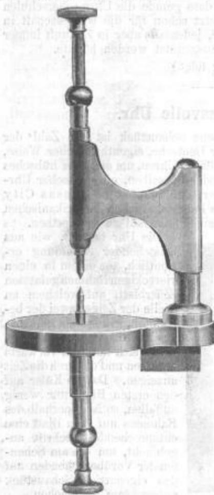
der Einspannknappe befindliche Broschenlager zusammengedrückt und dadurch die untere Brosche aus ihrer genauen Richtung gebracht wurde. Ein derartiges Vorkommniß ist bei dem vorliegenden Planteur völlig ausgeschlossen.
