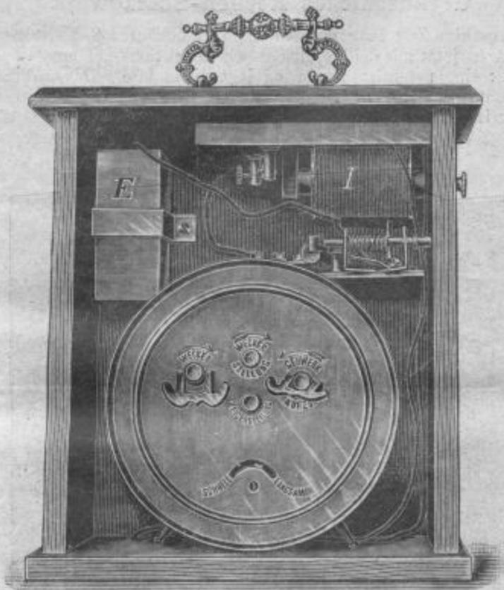
Fig. 1. Uhrwerk und Elektrisir-Apparat im Gehäuse
