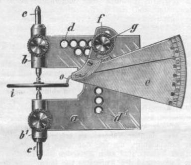
Wir bemerken zunächst die massive Grundplatte a, die mit zwei Spitzenlagern b b<sup>1</sup> versehen ist, beide durch einen Einschnitt getrennt. In diesem Einschnitt spielt zwischen den inneren Zapfenlagern der Spitzen c c<sup>1</sup> in der üblichen Weise die zu prüfende Unruhe i.
