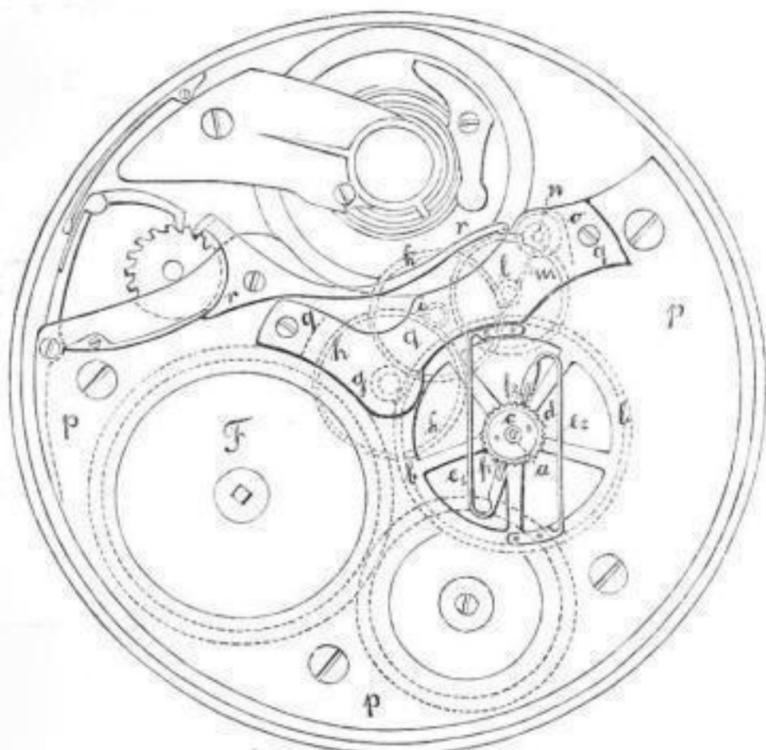
Auf dem oben starken Zapfen *a* des sogenannten Kleinbodentriebes sitzt das grosse Rad *b* lose; dasselbe wird durch einen am oberen Ende des Zapfens *a* aufgeriebenen Stahlputzen *c* gehalten. Mit letzterem ist ein kleines, mit Sperrzähnen versehenes Goldrädchen *d* fest verbunden, welches sich gleichzeitig mit dem Kleinbodentrieb umdreht.
