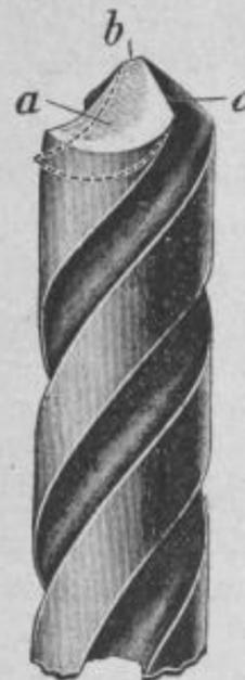
Ein für Messing zugeschliffener Bohrer würde in Eisen zuviel von diesem härteren Metall auf einmal fortnehmen wollen, so daß ein kleiner Bohrer dadurch abbrechen würde und man bei einem großen Bohrer das Arbeitsstück nicht festhalten könnte. Ein solcher Bohrer „reißt“, wie man sagt. Das Gleiche würde natürlich der Fall sein bei einem Bohrer
