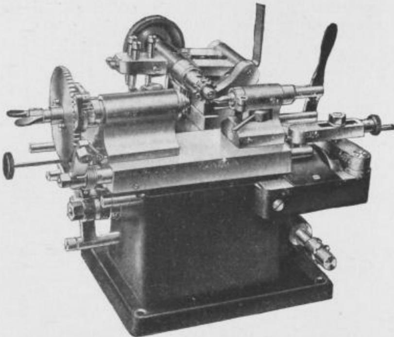
Halbautomatische Räder- und Triebfräsmaschine für Taschenuhren
